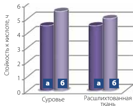
Рис. 8. Диаграмма изменения стойкости к кислоте композиционного МТМ суровье и расшлихтованной ткани, артикул 18422Х «Премьер Комфорт 250» (а – контрольный образец; б – модифицированный)
