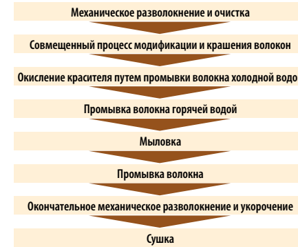
Рис. 2. Схема совмещенной технологии механохимической модификации лубяных волокон (льняных и конопляных) и крашения их кубовыми или сернистыми красителями
