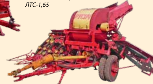
Льнокомбайн КЛ-1,5 (модификации «Русич», «Валдай», «Селигер», «Тверца»)
