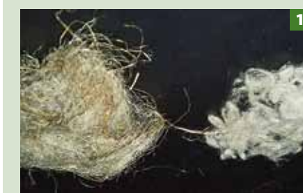
Рис. 1. Короткий лен до (слева) и после (справа) ударно-волновой модификации
