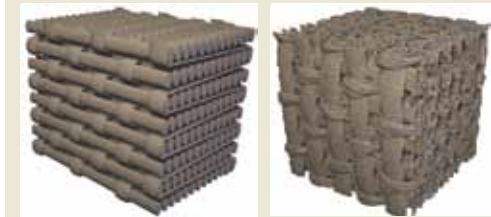
Рис. 2. Спроектированная 3D-модель преформы и томография изготовленной преформы из кремнеземного волокна
