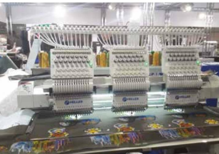
Рисунок 3 – Трехголовочное вышивальное оборудование марки «VELLES»
